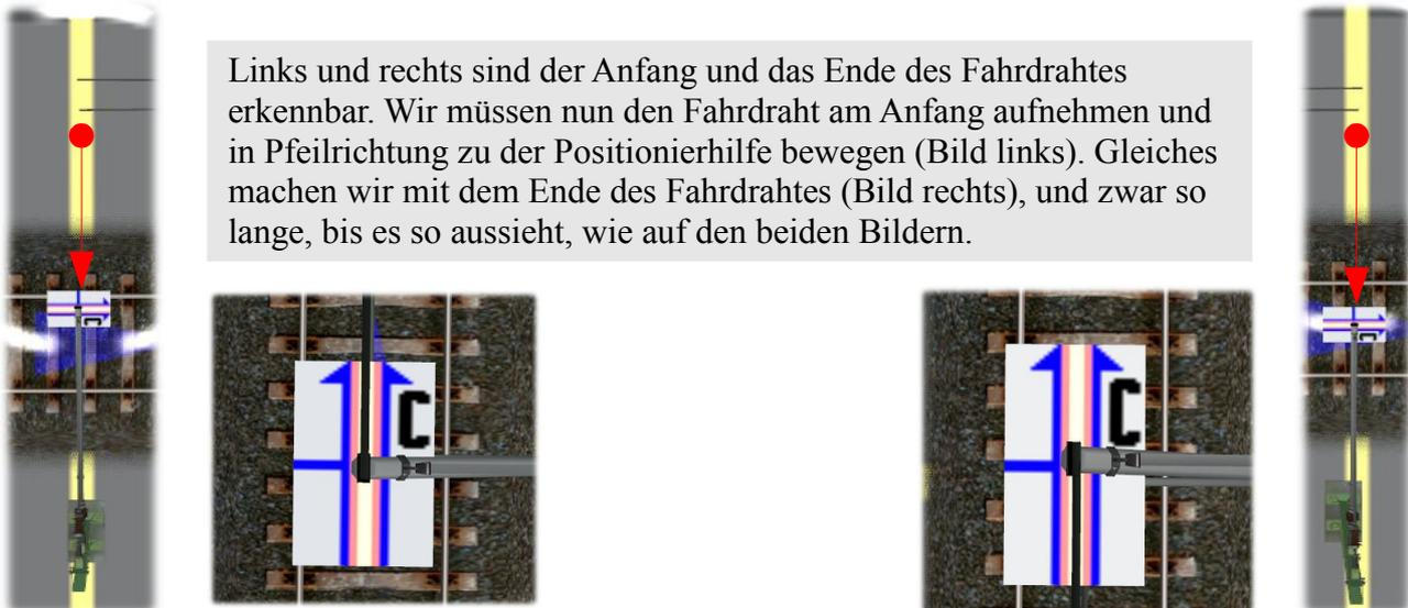
Zur Erläuterung: Bei dem schwarzen Strich, den wir auf beiden Bildern sehen, handelt es sich um den Anfang und das Ende des Tragseils der Fahrleitung. Das eigentliche Fahrseil ist nicht zu sehen, weil es sich unterhalb der weißen Fläche befindet. Trotzdem ist das Fahrseil korrekt am Fahrdralthalter befestigt, wie man das auf der nächsten Seite sehen kann .
