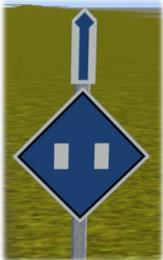
Der Pfeil senkrecht nach oben zeigt an, dass das Signal für den geraden Zweig oder bei Krümmungen für den schwächer gekrümmten Zweig der Weiche gilt.
