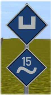
Im Bereich von Systemwechseln kann das Signal E12 durch ein zweites Signal ergänzt werden.
